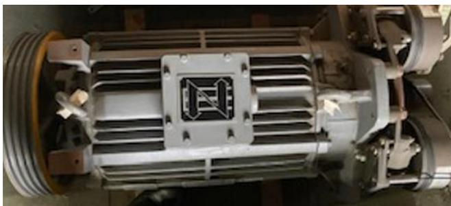
ピット置タイプ巻上電動機
