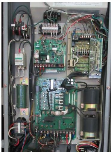
速度制御(インバータ駆動)装置
